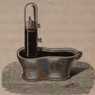
Fig. 9. Décomposition de l'eau par le sodium.
